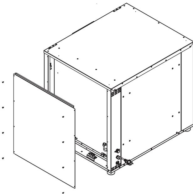
3.4.2.6. Закройте боковую стенку при помощи винтов и зафиксируйте кабель, закрутив гайку кабельного ввода.
